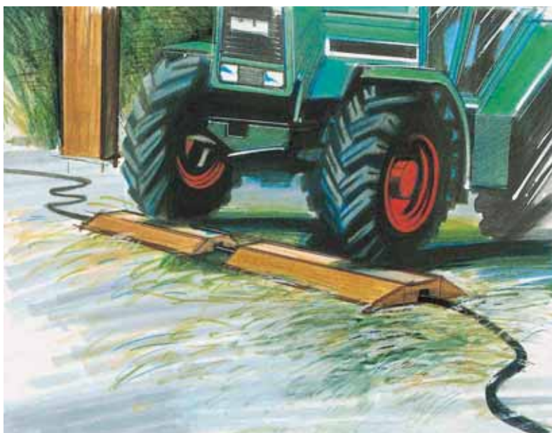
Fig. 7 - Corretta protezione del cavo elettrico
