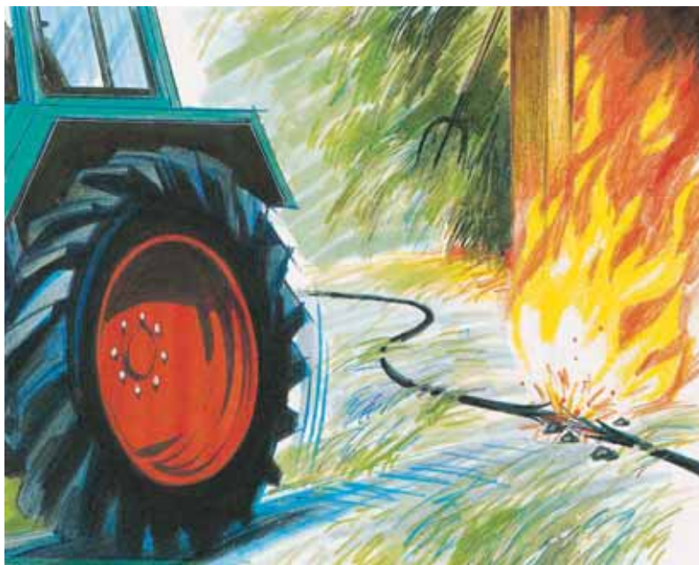
Fig. 6 - Il cavo elettrico schiacciato può provocare un incendio
