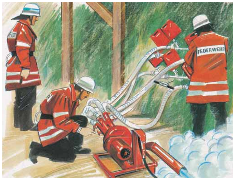
Fig. 20 - Apparecchio antincendio per fieno
